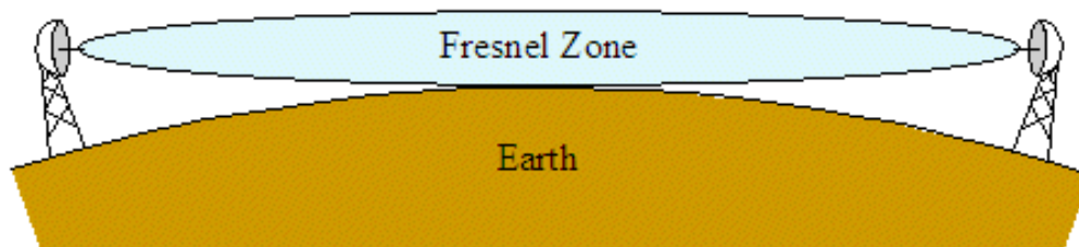
Figur 8.14.2. Fresnel zonen er defineret som en ellipsoide mellem to antenner inden for, hvilken radiofrekvens linjerne ligger inden for en halv bølgelængde af den totale længde af strækningen (RABC 2010).
